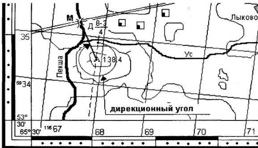
Дирекционный угол с точки стояния отметка 138.4 на точку М (мост) = 330°
