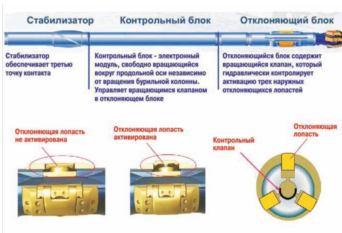
Рис. 10 РУС с радиальным смещением компоновки относительно оси скважины, вызывающая давление на боковую поверхность долота в определенном направлении
