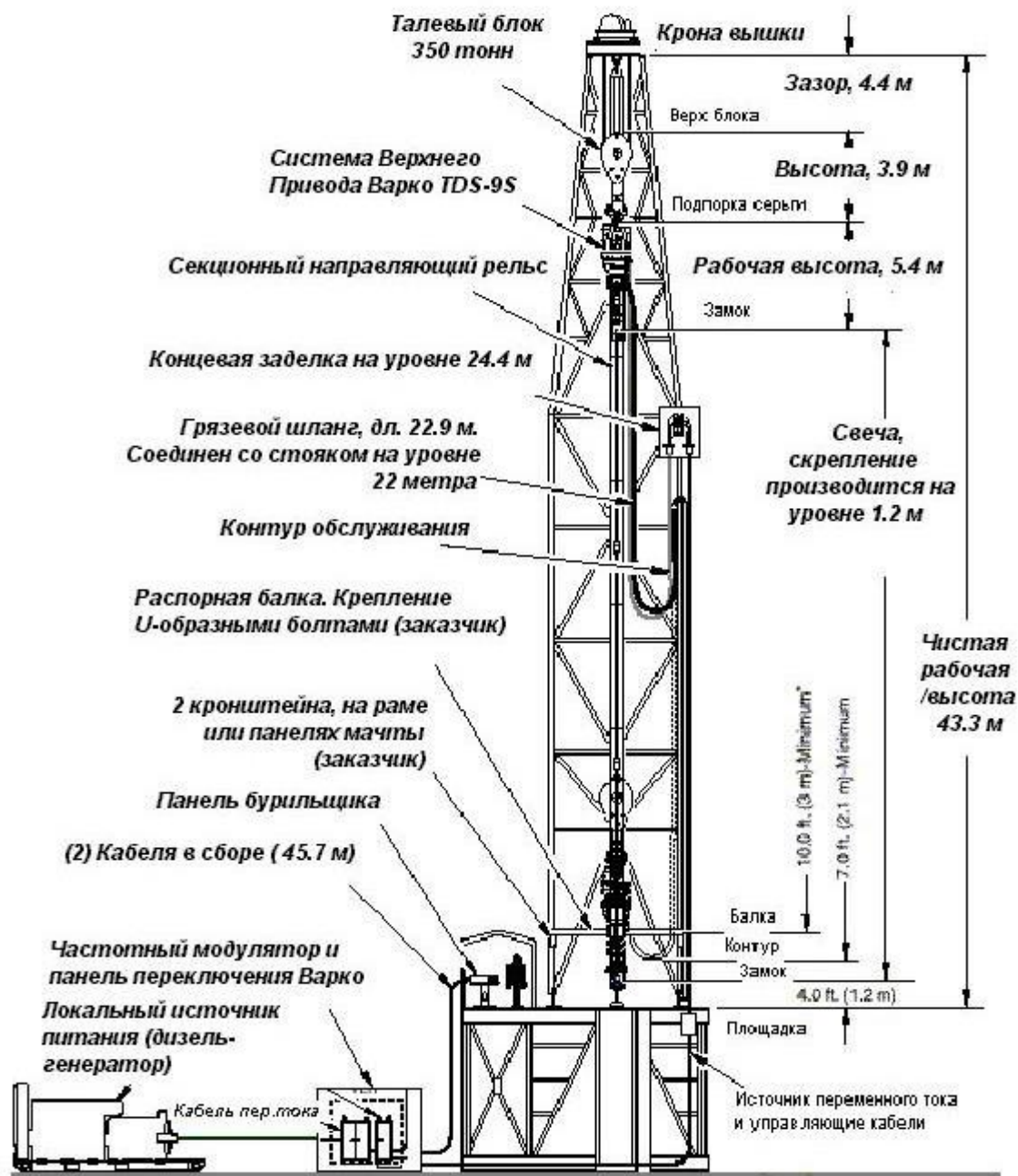
Рис.9. Стандартная привязка СВП к буровой вышке.
