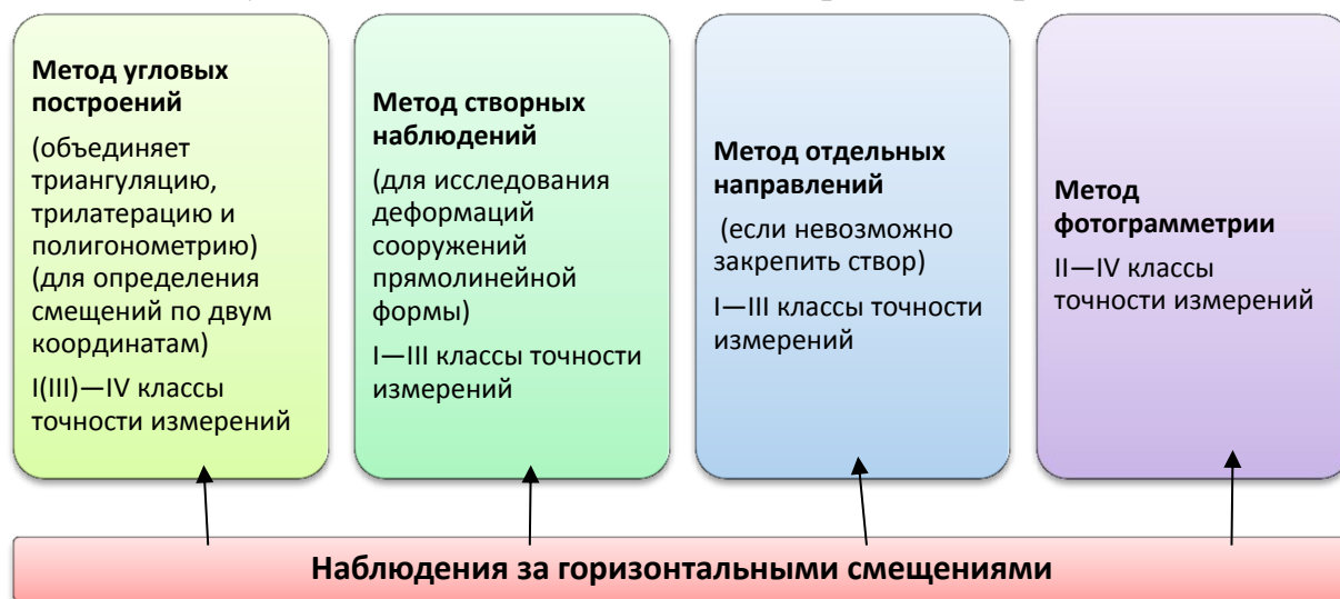
Рис. 9.10. Методы наблюдения за горизонтальными смещениями сооружений
