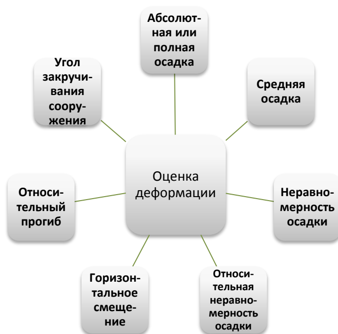
Рис. 9.2. Параметры оценки деформаций сооружений
