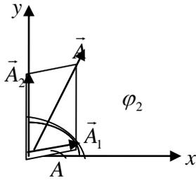
Согласно теореме косинусов амплитуда результирующего колебания определяется соотношением
