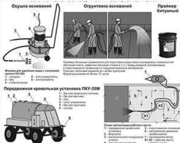
Рис.2 Устройство защитных и изоляционных покрытий.
