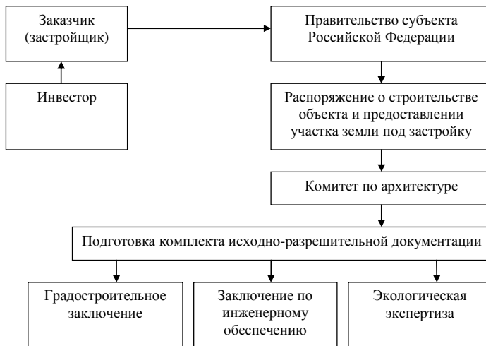
Рис. 47. Схема подготовки исходно-разрешительной документации
