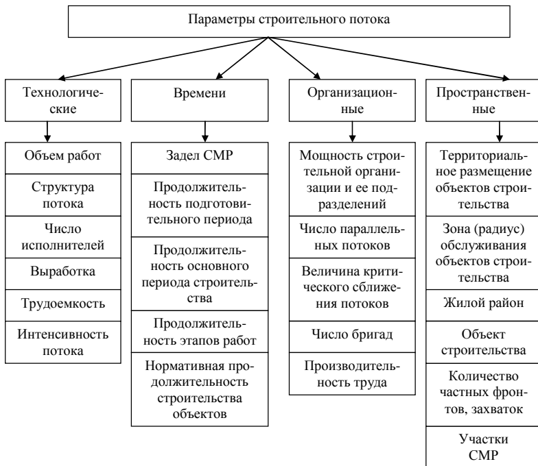
Рис. 30. Классификация параметров строительного потока
