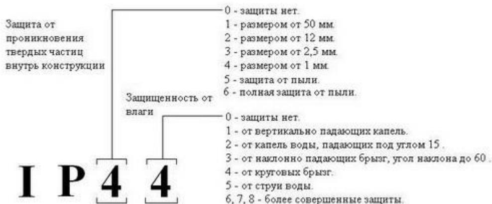
Степень защиты светильников от пыли и твердых частиц маркируется цифрами от 0 до 6. Чем меньше указанное значение, тем слабее уровень внешнего воздействия, которое осветительный прибор сможет выдержать без последствий. Если первая цифра равна 0, это означает, что оболочка светильника не защищает прибор ни от проникновения внешних предметов и пыли, ни от доступа к опасным частям.
