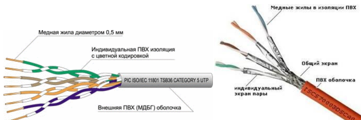
Рисунок 5.25 – Неэкранированная и экранированная витая пара
