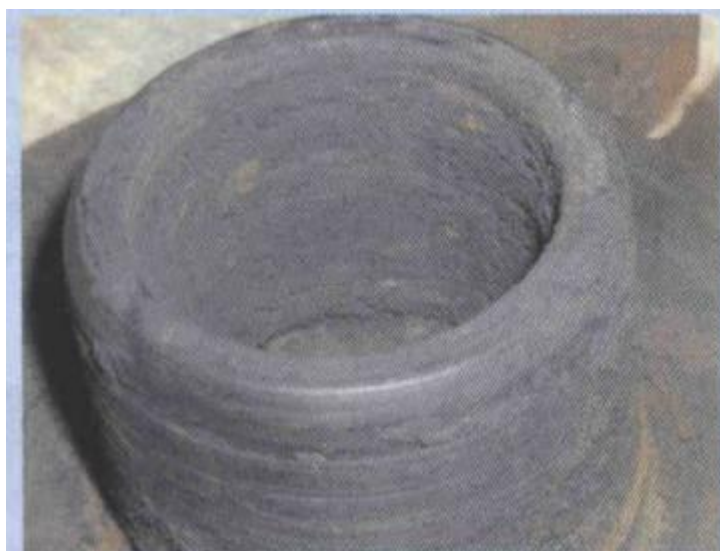
Рис. 3. Разрушенный упорный подшипник подвижной спирали
