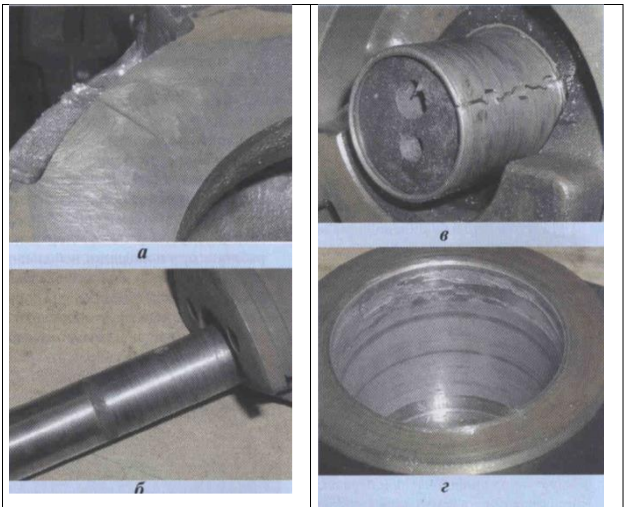
Рис. 5. Повреждения деталей спирального компрессора из-за плохой смазки: а — изношенный упорный подшипник; б — следы заклинивания на верхнем подшипнике коленвала; в — выкрашивание подшипника; г — задиры опорного подшипника подвижной спирали.
