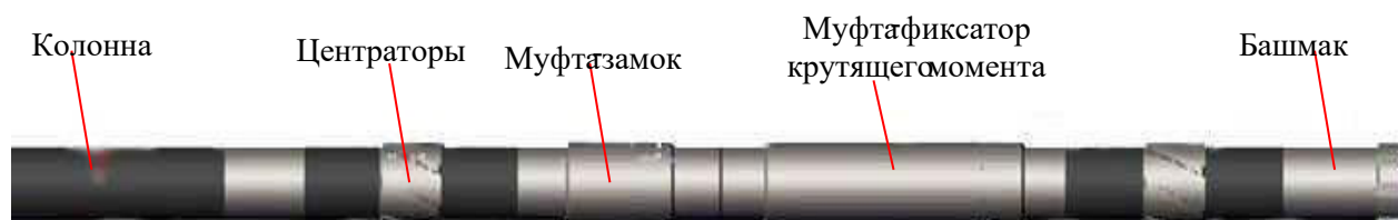
Рисунок 2 – Сборка обсадной колонны
