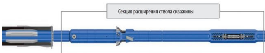
Рисунок 27 – Гидравлический расширитель перед обсадной колонной
