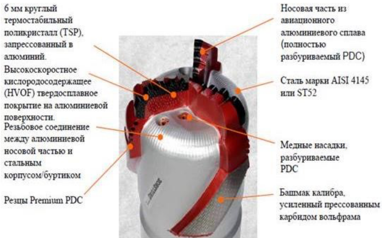
Рисунок 19 – Конструкция долота DrillShoe
