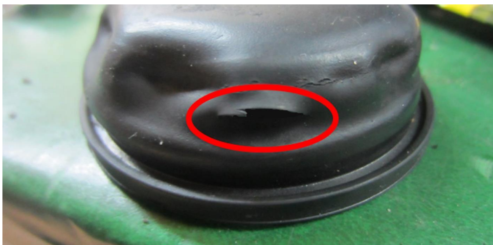
Рисунок 3.1.1 – Трещина в диафрагме насоса
