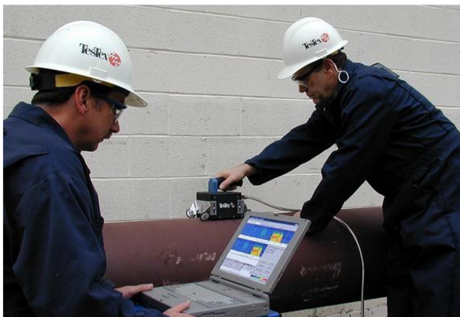
Рисунок 2 – проведение акустического контроля
