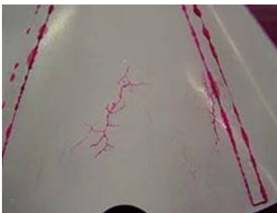
Рисунок 4 - Дефекты, обнаруженные капиллярным методом контроля
