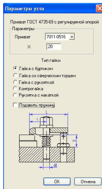
Рисунок 3 - Прихват с регулируемой опорой по ГОСТ 4735-69
