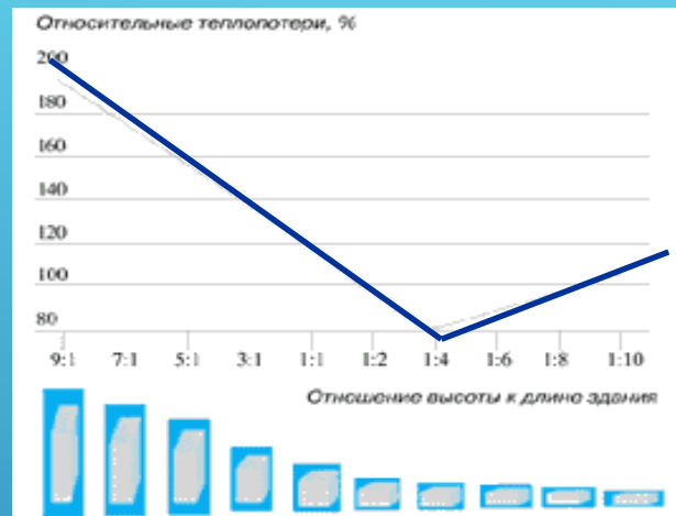
Зависимость теплотерь здания от его формы и отношения площади поверхности к объему
