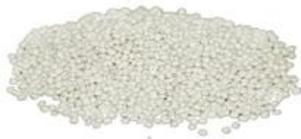
Рисунок 2 – Каолин гранулированный
