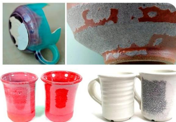
Рисунок 6 – Дефекты глазури при обжиге керамики
