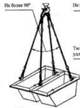
Строп 4 СК1-3,2+4 СК1-10,0 Q = 3,2+10,0 тс при подаче пустой тары P = 54 \times 2 = 108 кг
