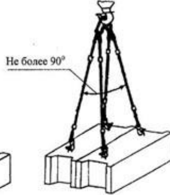
Строп 4 СК1-5,0+4 СК1-10,0 Q = 5+10 тс при разгрузке блоков стен подвала P = 1,96 + 3,94 т
