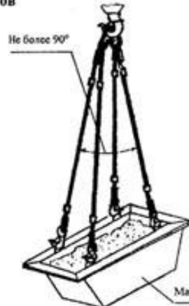
Строп 4 СК1-3,2+4 СК1-10,0 Q = 3,2+10,0 тс при подаче ящика с цементным раство- ром емкостью 0,28 м 3 P = 0,65 т
