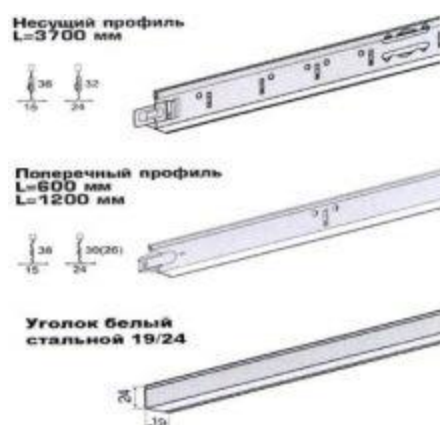
Рис.2. Соединительные элементы подвесной системы
