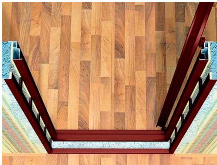
Рис.7. Схема установки контр-рамы для установки металлической двери в проем бетонной, кирпичной или блочной стены
