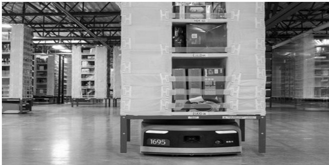
Рисунок 2 – Роботизированный комплекс «Kiva 2»
