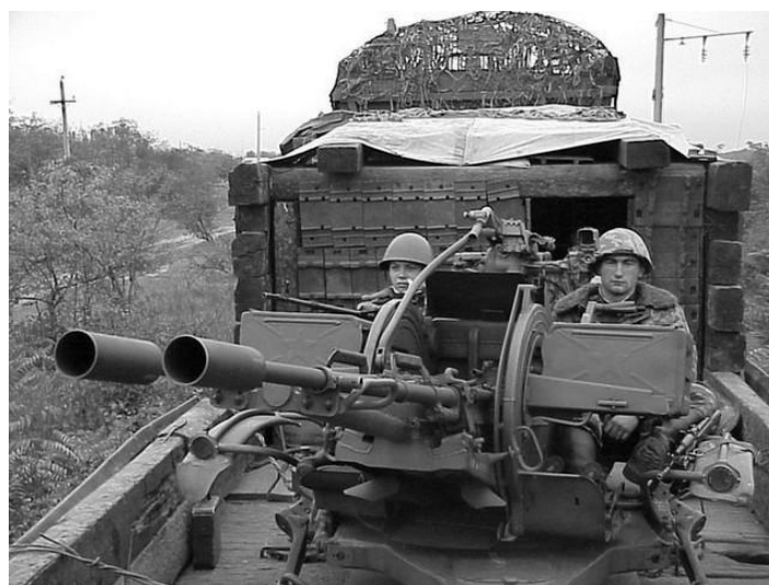
Рисунок 2 – Защитное сооружение на платформе прикрытия бронепоезда
