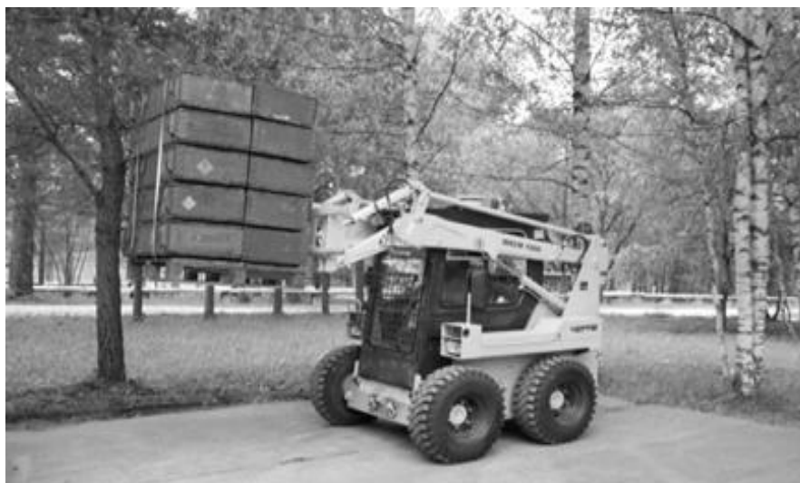
Рисунок 2 – Вилочный погрузчик на базе многофункциональной коммунальной строительной машины МКСМ-1000
