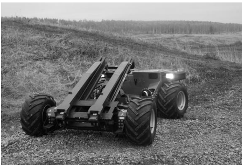
Рисунок 3 - Универсальная самоходная машины (УСМ-1)
