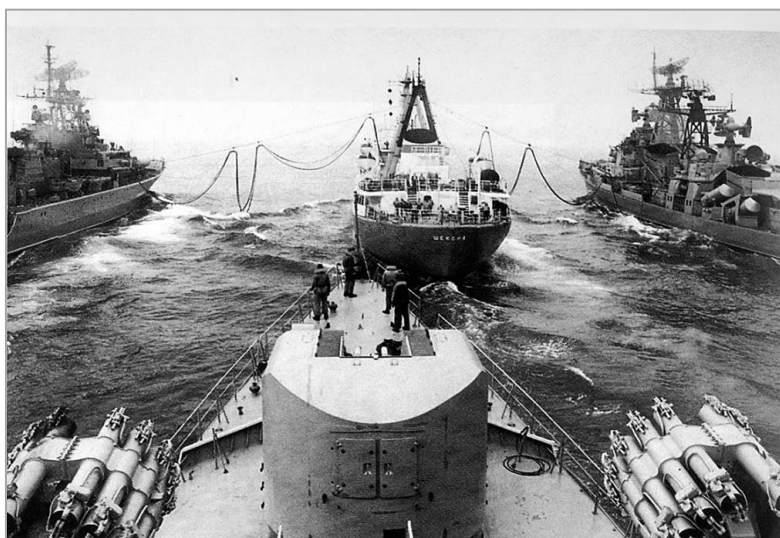
Рисунок 1 – Передача грузов с большого танкера на корабль
