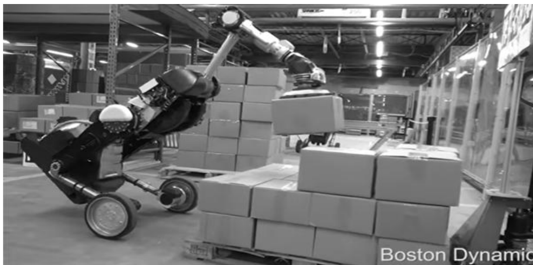
Рисунок 3 – Двухколесный балансирующий робот «Handle» (Япония)
