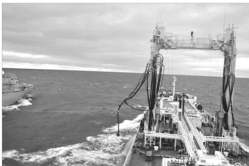
Рисунок 2 - Вооружение шланговой линии для передачи горючего
