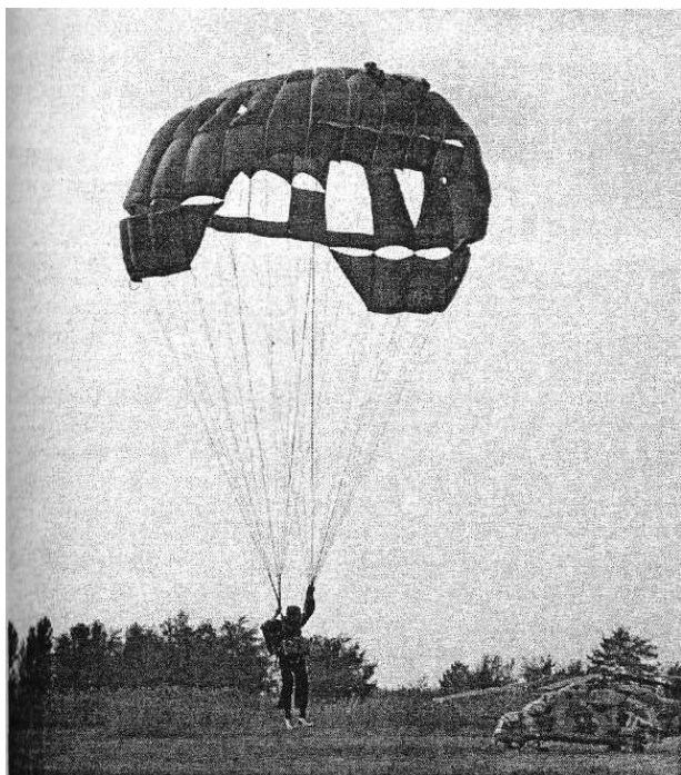
Рис. 26. Спортивно-тренировочный парашют УТ-15, имеющий аэродинамическое качество около единицы
