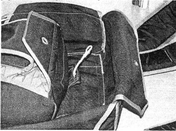
Рис. 9. Ранец Javelin: контейнер основного парашюта
