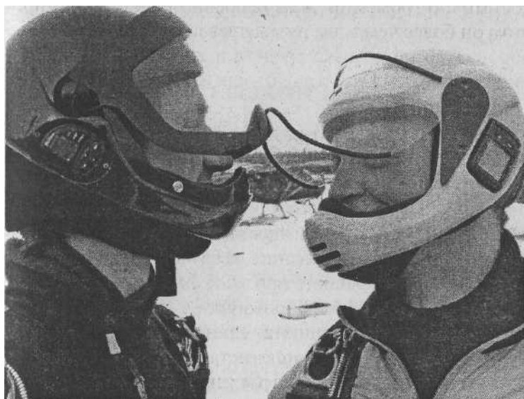
Рис. 62. Пищалки Skytronic (слева) и ProTrack (справа), установленные на шлемы
