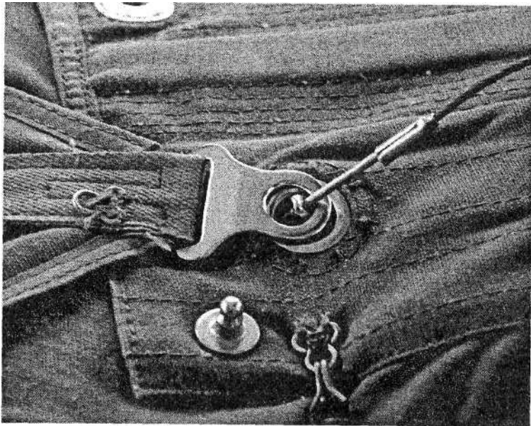
Рис. 7. Шпилька, провалившаяся в люверс РАНЕЦ
