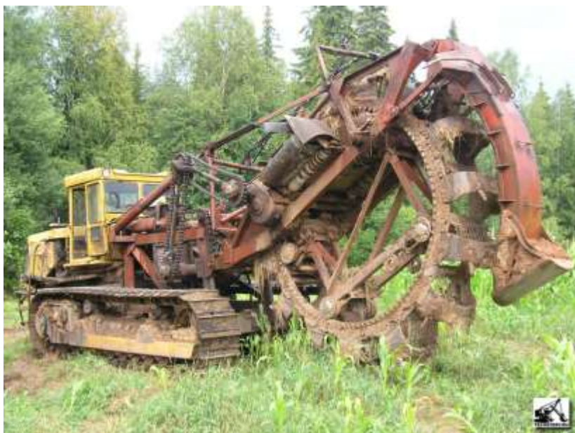
Роторный траншейный экскаватор
