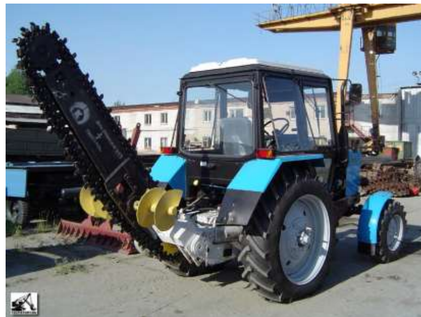
Экскаватор траншейный цепной
