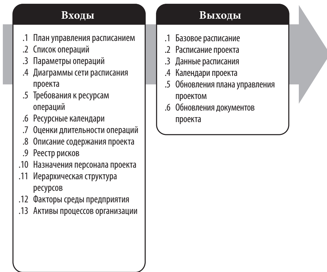
Рис. А1-18. Разработка расписания: входы и выходы
