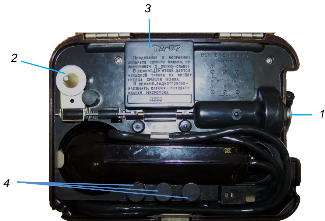
Рис. 4.2. Детали разговорной и вызывной цепей ТА-57 (микротелефонная трубка уложена в ящик): 1 – ручка индуктора, 2 - рычажный переключатель (РП), 3 - откидная крышка гнезда батареи питания, 4 – линейные клеммы.
