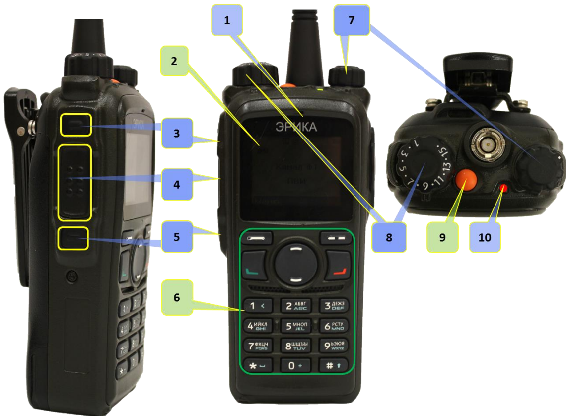
Рис. 3.6 Органы управления радиостанции «Эрика-360.01»
