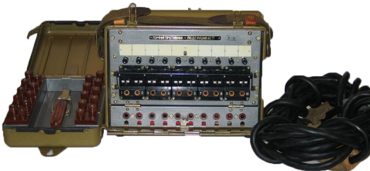
Рис. 4.7. Полевой телефонный коммутатор П-193М
