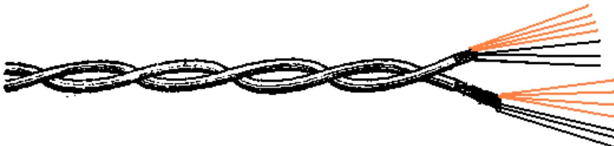
Рис. 4.14. Полевой телефонный кабель П-274
