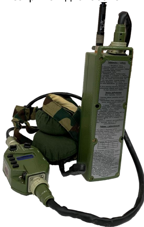
Рис. 7.6. Рабочий комплект радиостанции Р-168-1К
