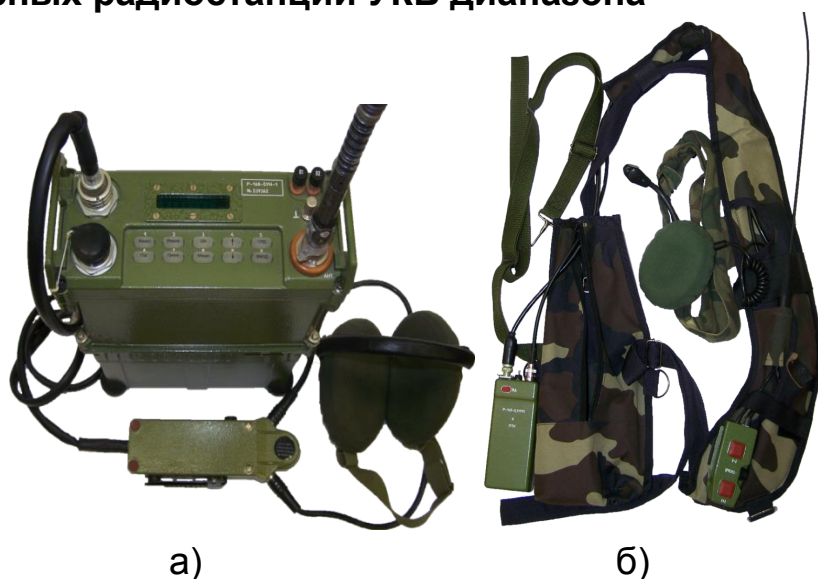
Рис. 5.1 Переносные радиостанции УКВ диапазона: а) P-168-5УН-1, б) P-168-0,1УМ1
