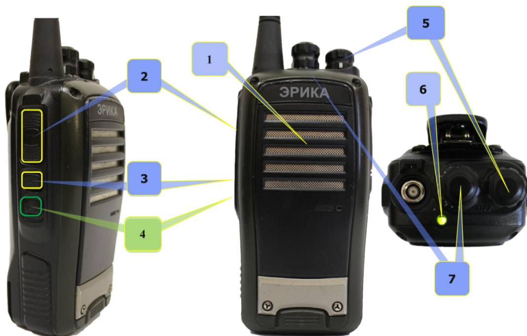
Рис. 3.5 Органы управления радиостанции «Эрика-315»
