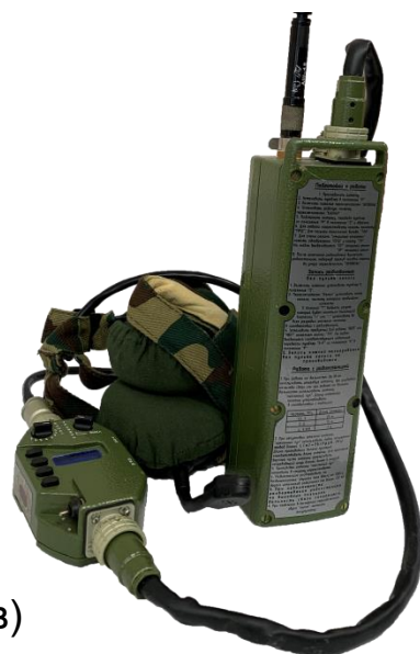
Рис. 5.1 Радиостанции КВ диапазона: а) P-168-100KA, б) P-168-5KH, в) P-168-1K
