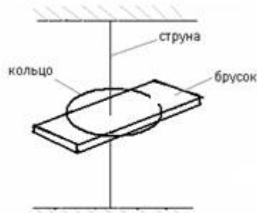
Рис. 1 Установка для изучения крутильных колебаний
