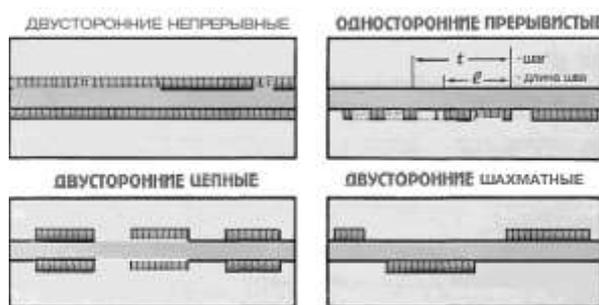
Рисунок 6 – Виды сварных соединений по протяженности и взаимному расположению
