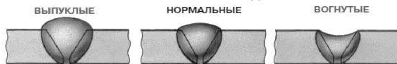
Рисунок 4 – Виды сварных соединений по степени выпуклости
