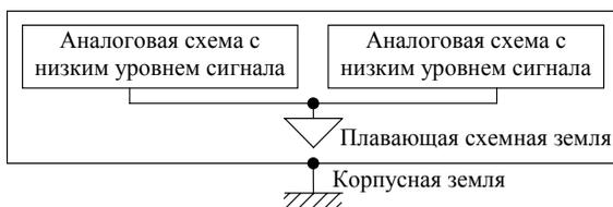
Рис. 1.35. Схема с плавающим заземлением
