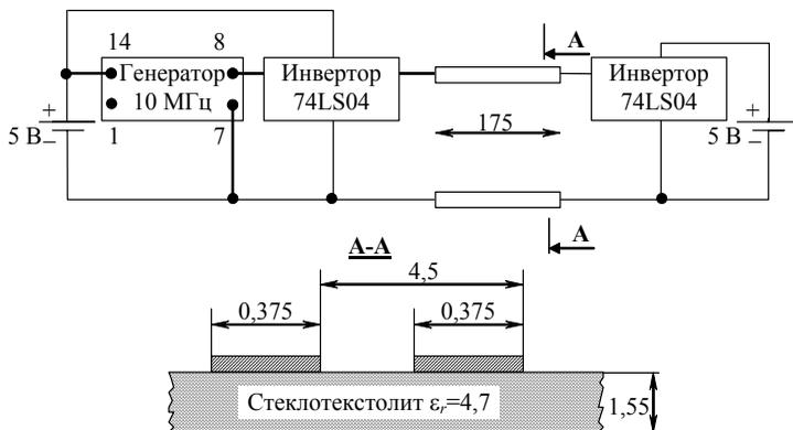
Рис. 1.15. Схема простого эксперимента, демонстрирующего трудность удовлетворения ограничениям на излучаемые эмиссии. (Размеры в мм.)
