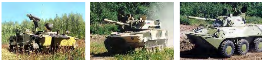
Фото 1.7. Всепогодный круглосуточный многоцелевой ракетный комплекс «Хризантема-С», 120-мм автоматизированное самоходное орудие «Вена», 120-мм самоходное орудие «Нона-СВК»
