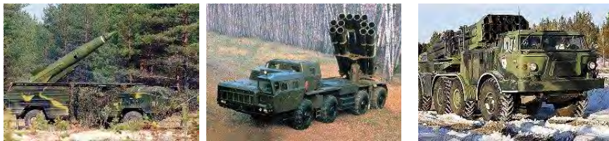
Фото 1.4. Модернизированный тактический ракетный комплекс «Точка-У», 300-мм дальнбойная реактивная система залпового огня «Смерч», 220-мм реактивная система залпового огня «Ураган»
