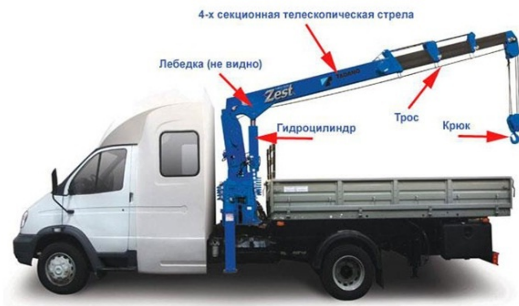
Рисунок 1. Основные узлы крана-манипулятора.
