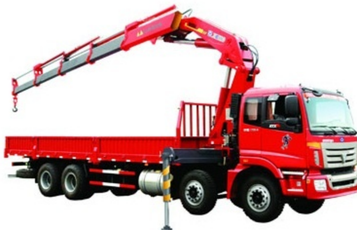
Рисунок 6. Кран-манипулятор модели SQ16ZK4Q, имеющий стрелу Z-образного типа.
