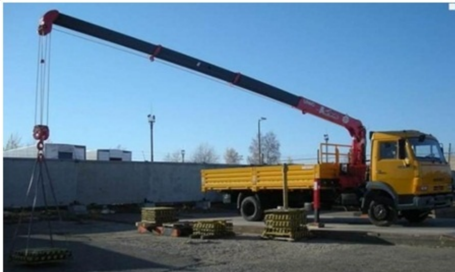
Рисунок 7. В работе кран-манипулятор с L-образным стреловым оборудованием.
