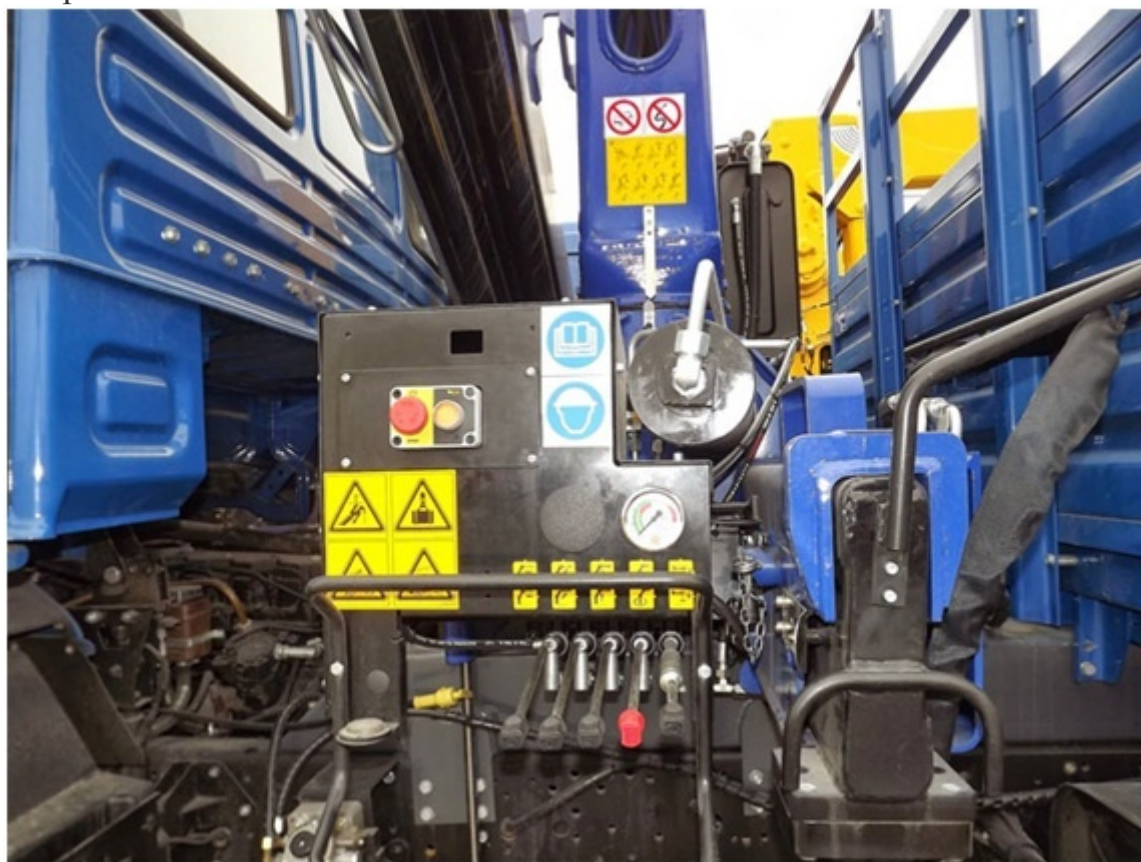
Рисунок 8. Система управления крана-манипулятора.
