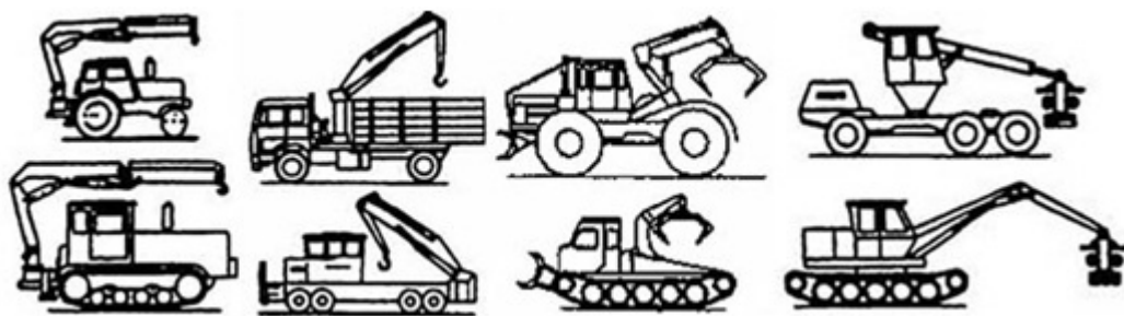
Рисунок 9. Краны-манипуляторы с разным шасси внешне сильно отличаются друг от друга.
