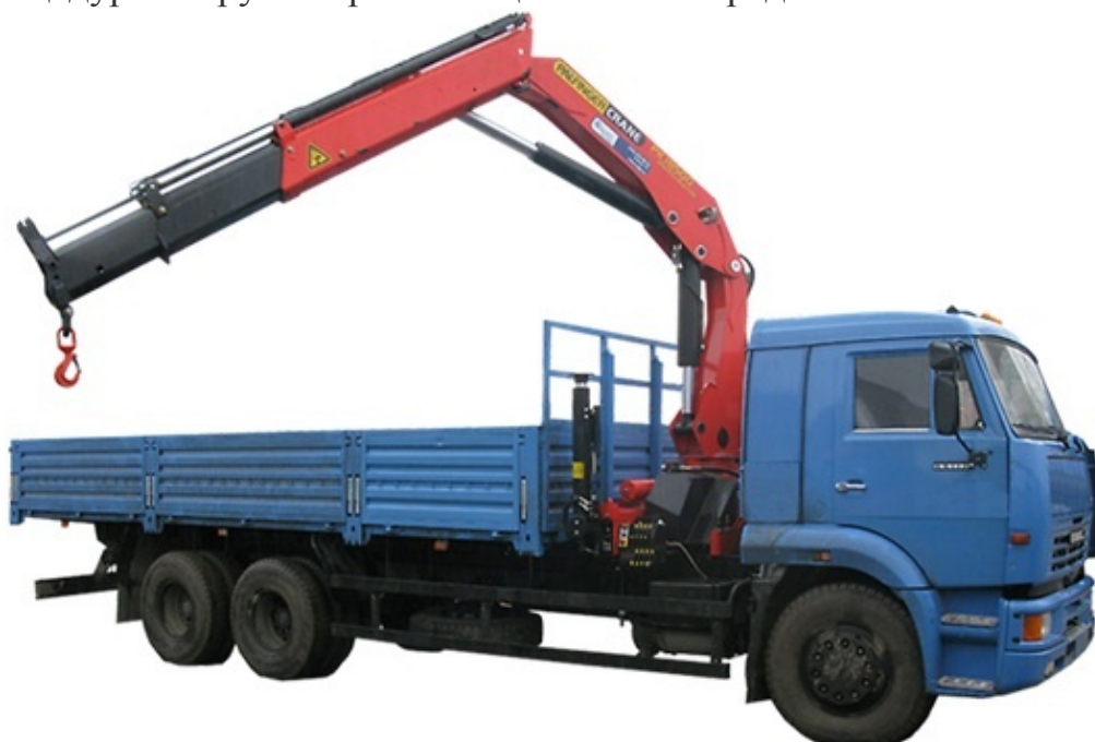
Рисунок 10. Грузовая машина с КМУ и бортовой платформой без тента –типичный представитель кранов-манипуляторов.
