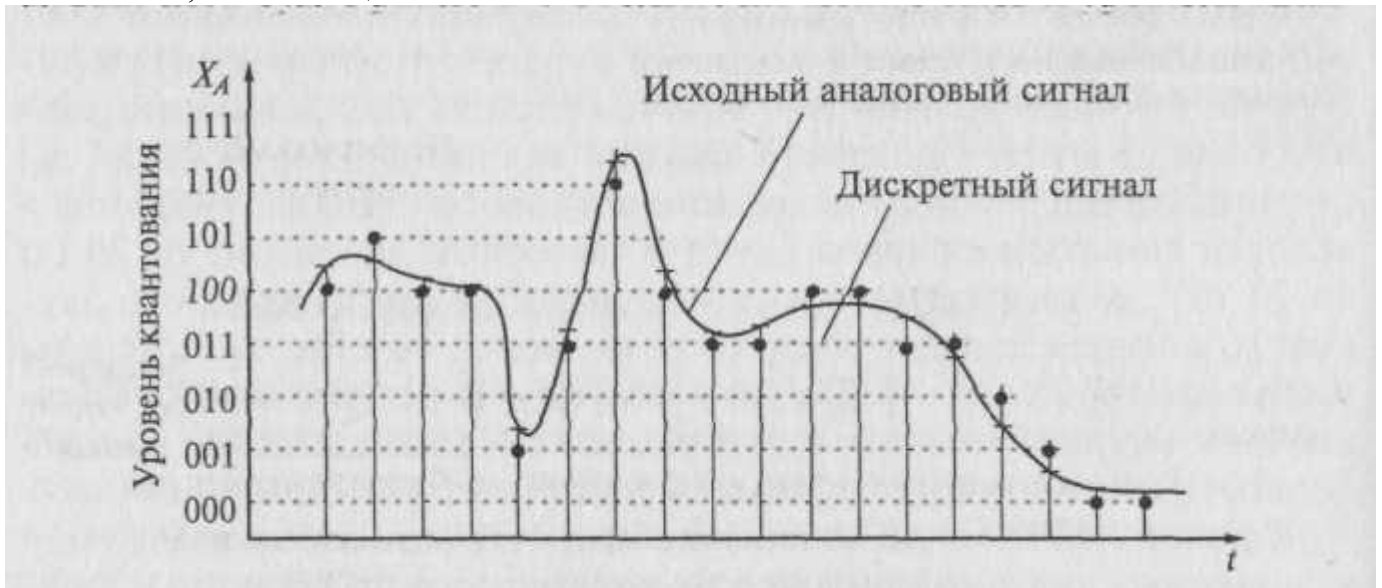
Рис. 3. Дискретизация по времени и квантование по уровню аналогового сигнала
