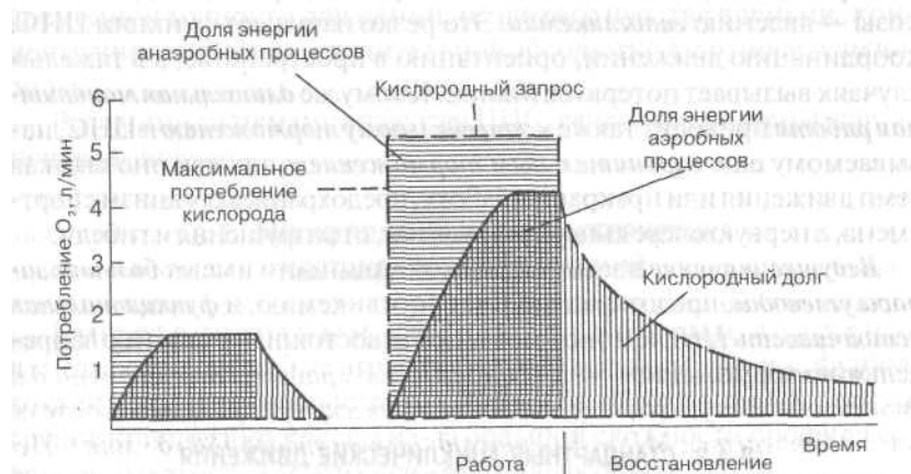
Рис. 30. Кислородный запрос, потребление кислорода и кислородный долг при легкой аэробной (слева) и тяжелой анаэробной работе (справа) 261
