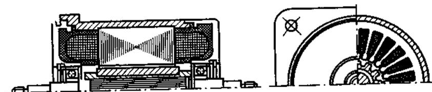
Рисунок 34 – Шаговый двигатель типа ШД-2 с активным ротором в виде магнита-звездочки
