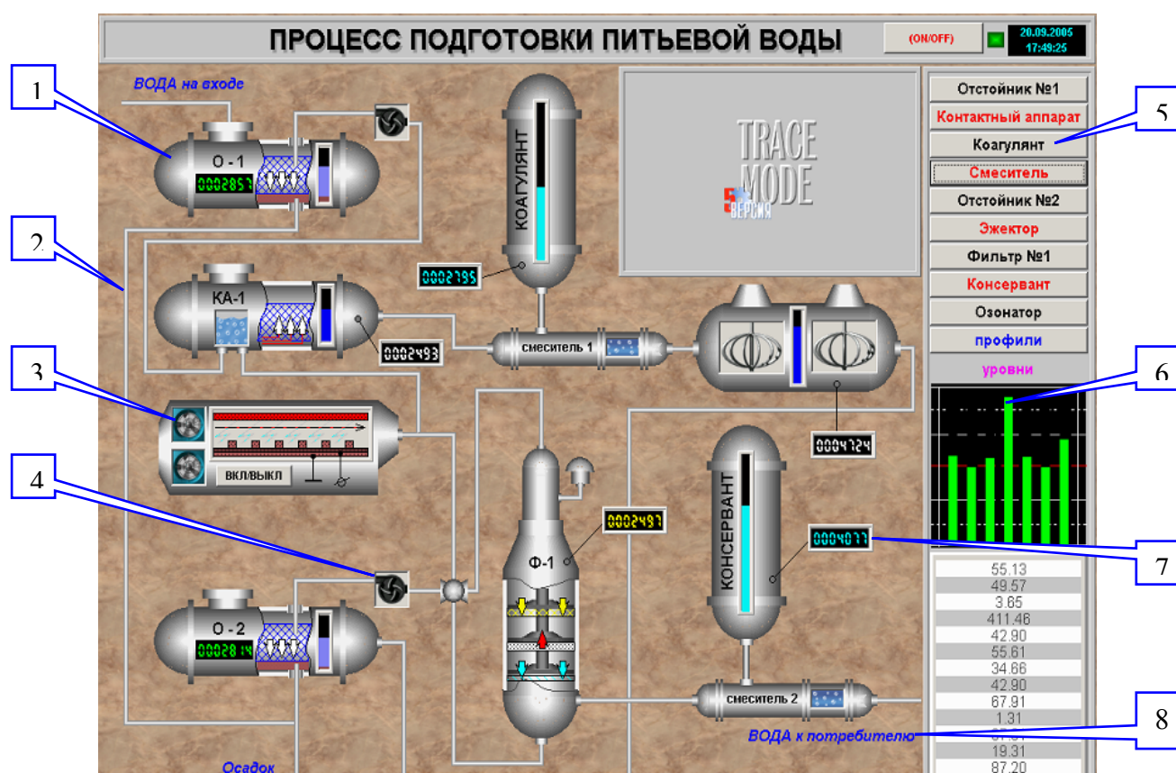
Рис. 134. Пример графического интерфейса оператора, контролирующего процесс подготовки питьевой воды, созданного в системе Trace Mode
