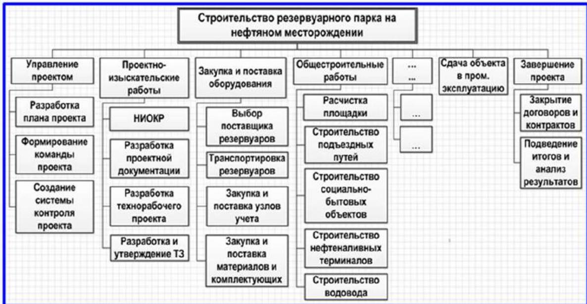
Рис 3.8. Пример функциональной иерархической структуры
