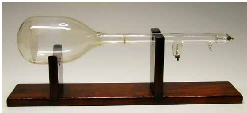
Рис. 6.5. Катодная трубка Брауна
