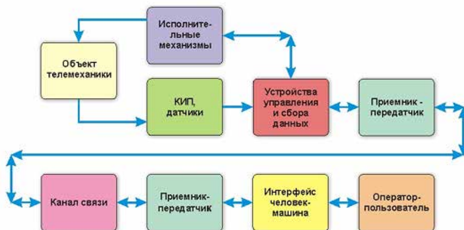
Рис. 9.2. Функциональная схема системы телемеханики
