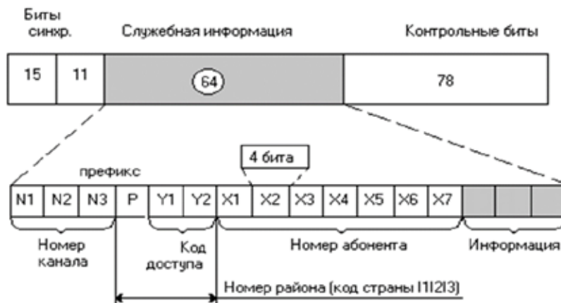
Рис. 4.5. Структура кодовой последовательности стандарта NMT-450
