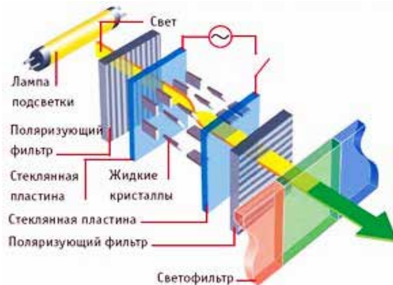
Рис. 6.10. Устройство жидкокристаллического дисплея
