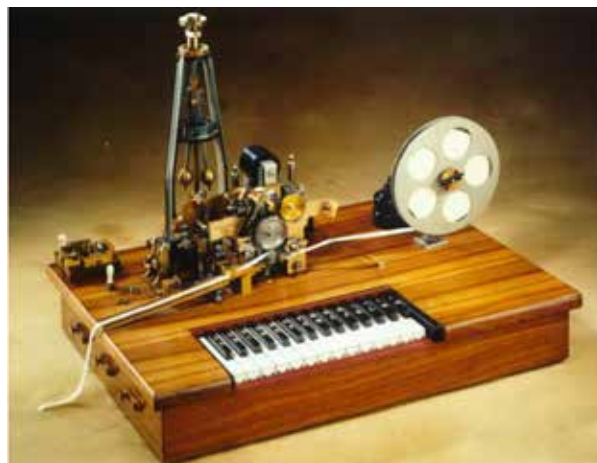
Рис. 2.13. Телеграфный аппарат Д. Хьюза
