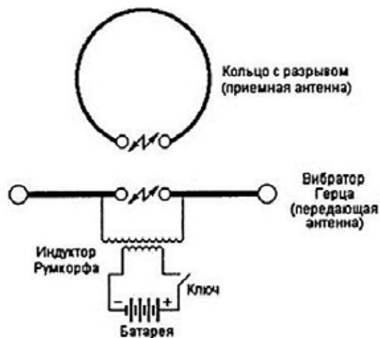
Рис. 3.4. Схема опытной установки Герца для подтверждения наличия радиоволн
