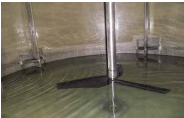
Футерованные резиной пропеллеры для минеральной взвеси.
