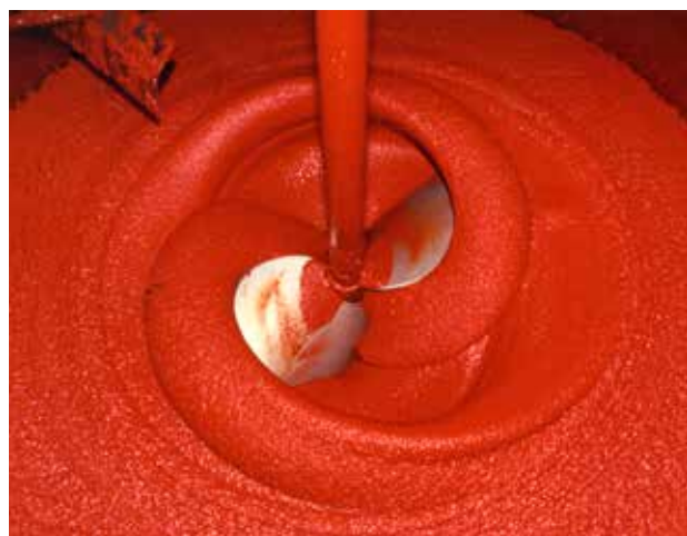
Гомогенизация кетчупа с помощью мешалки Scaba в гигиеническом исполнении.
