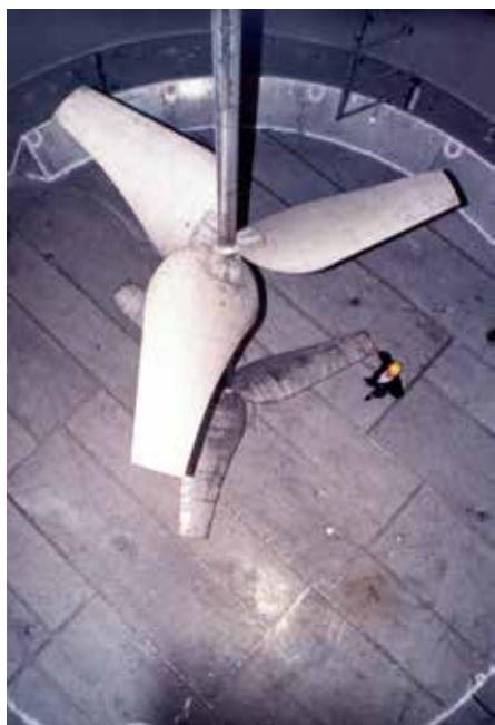
Вертикальная мешалка для бумажных химикатов. Пропеллер двойного действия для вязких жидкостей и пульпы.
