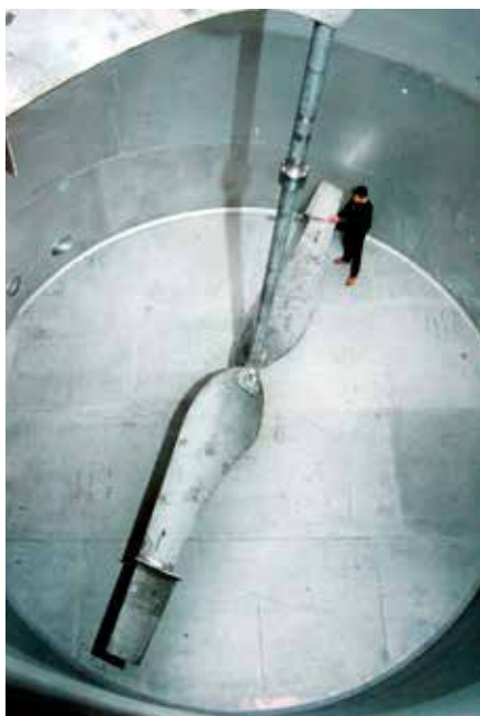
Вертикальная мешалка для бумажных химикатов. Пропеллер двойного действия для вязких жидкостей и пульпы.
