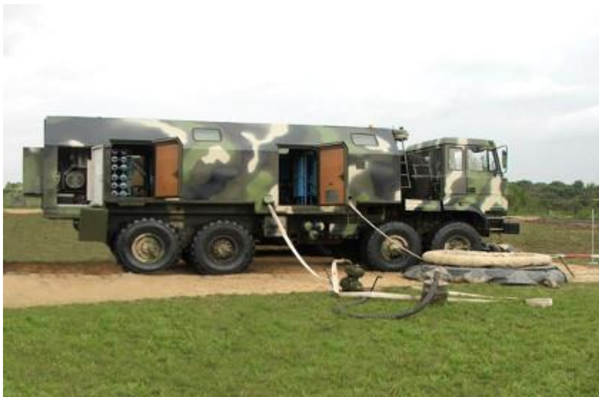
Рис. 21. Станция комплексной очистки воды СКО-10К
