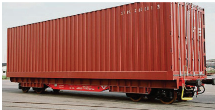
Рис. 1. Специальные морские контейнеры компании «Stora Enso» грузоподъемностью до 80 т: а – контейнер SECU; б – контейнер SECU (по центру) в сравнении с контейнерами стандарта ISO; в – контейнер SECU, установленный на железнодорожную платформу
